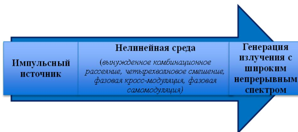
Рис.1. Блок-схема генерации СК
