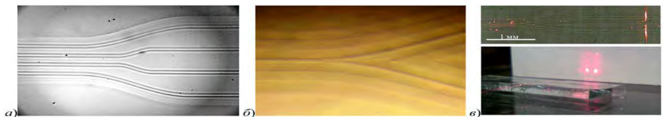
Рис. 2. Примеры планарных полимерных структур: уплотнитель каналов (а), Y-структура (б), деление лазерного излучения Y-структурой (в)
