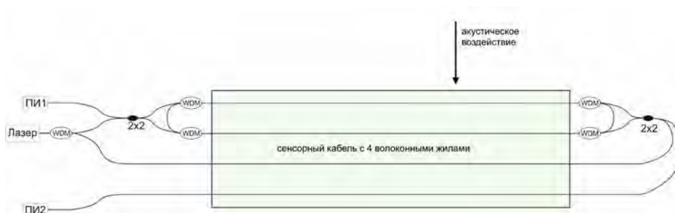
Рис. 1. Схема акустического датчика на основе двух петель РИС с мультиплексированием длин волн
