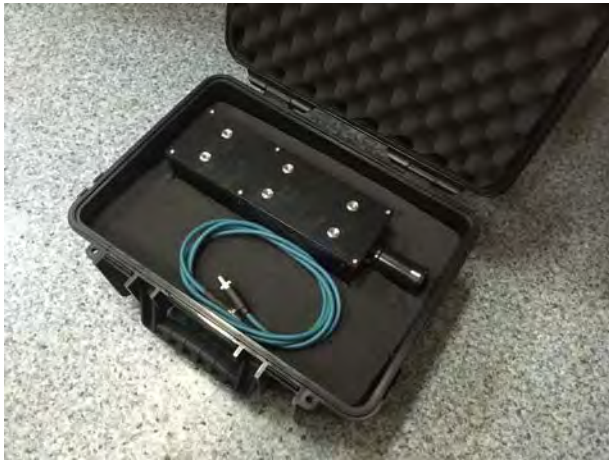
Рис. 1. Акустооптический гиперспектрометр: а) вид в транспортировочном кейсе; б) интерфейс управления в одном из режимов
