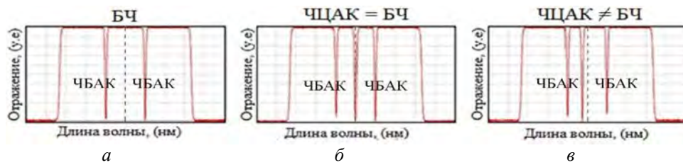
Рис. 3. ТАВБС, работающие на пропускание 3\pi -ВБР (варианты): а – БЧ в середине между ЧБАК; б – БЧ совпадает с ЧЦАК; в – БЧ не совпадает с ЧЦАК
