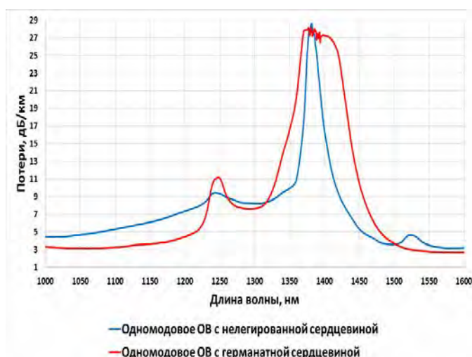
Рис. 1. Спектральные оптические потери ОВ в медном ЗУП
