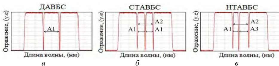
Рис. 1. ТАВБС, работающие на пропускание 3\pi -ВБР:
