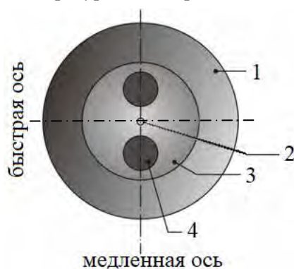
Рис. 1. Изображение торца ПАНДА с осями поляризации:
