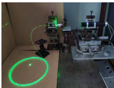
Рис.1. Фотография бухты светящегося КП-ОВ/Tefzel/200 мкм длиной 50 м (диаметр бухты – 190 мм) при его засветке излучением лазера LG Laser 303 (длина волны излучения – 532 нм). Ввод излучения в волокно – через объектив \times 10, 0.4
