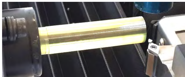
Рис. 2. Заготовка сердцевины оптического волокна для экструзии (КРС-13)
