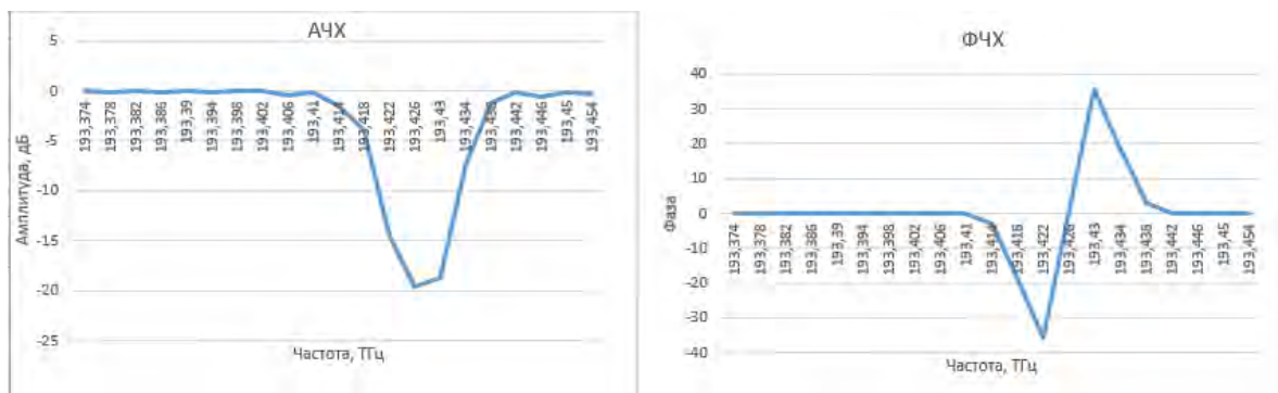
Рис. 4. Амплитудно-частотная и фазово-частотная характеристики тестируемой ВБР
