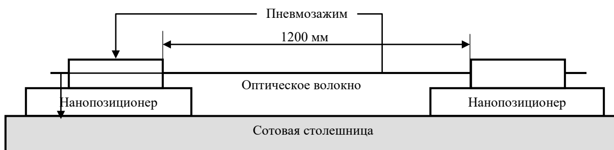
Рис. 1. Схема установки по определению коэффициент оптической тензочувствительности
