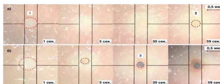
Рис. 1. Временная динамика абляционного процесса при воздействии а) непрерывным и б) импульсным лазерным излучением средней мощностью ~300 мВт 1 – зона, подверженная воздействию лазерного излучения, 2 – зона абляции, 3 – абляционный кратер
