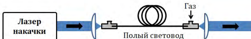
Рис.2. Типичная односторонняя схема газовых волоконных лазеров
