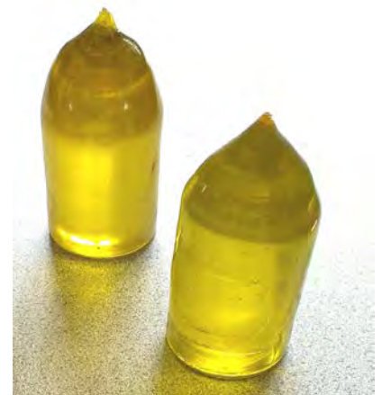
Рис. 1. Кристаллы КРС-13 для сердцевины оптического волокна
