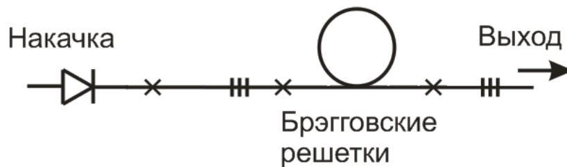
Рис. 2.17. Схема лазера с отражателями на основе брэгговских решеток
