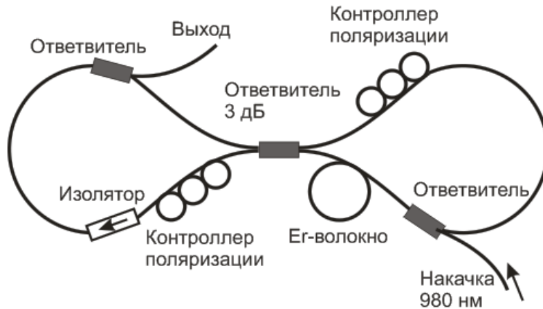
Рис. 7.2 Схема лазера в форме восьмерки
