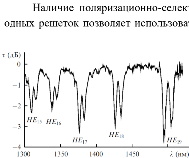
Рис. 4.13. Спектр пропускания длиннопериодной решетки, записанной в волокне с двулучепреломлением
